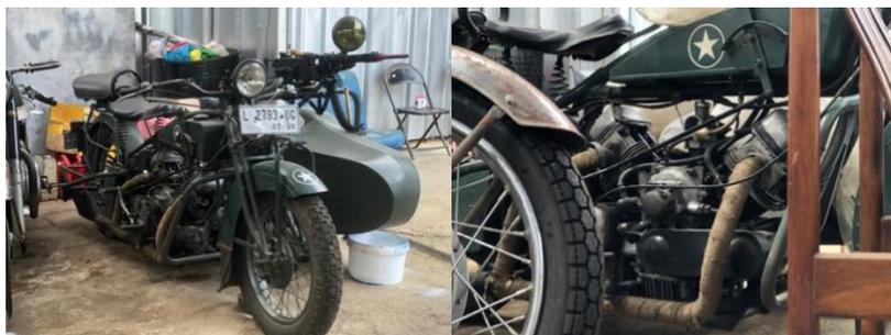
Gambar 10. Motor kustom bermesin Mazda Hasil Yudi
